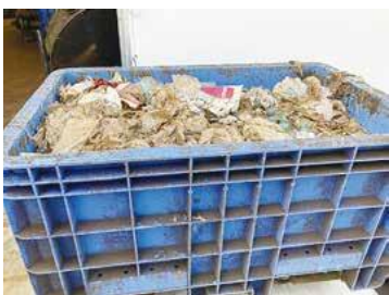
破除袋機から排出された袋
