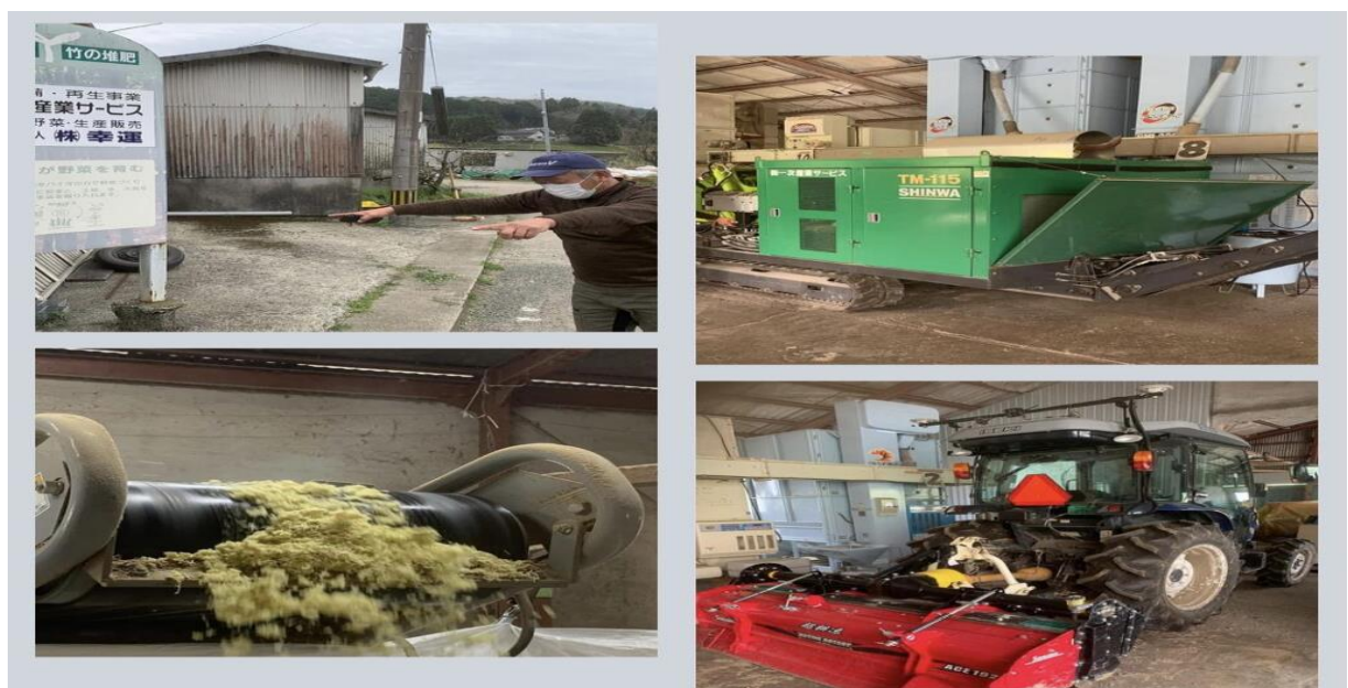
🔪 粉砕機で竹を繊維状にして、おからと混ぜ合わせて堆肥を作ります。
