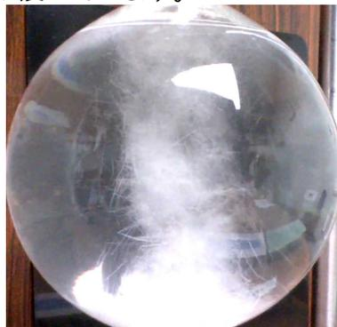
晶になるときにでてくる熱で体を温めようというのが、人気商品にはならなかったようですが、ウェットスーツに応用されたことがあります。今回水溶液の温度が人肌ぐらいあったので反応が遅かったのですが、もっと冷やして実験すればもっと早く結晶化して、熱も一気に出るのだから熱くなるのを経験できます。この実験校長室で生で見たい人は予約して下さい。結晶を溶かした後、上手に冷やして待ってますね！何人か一緒に来てくれると嬉しいです。
