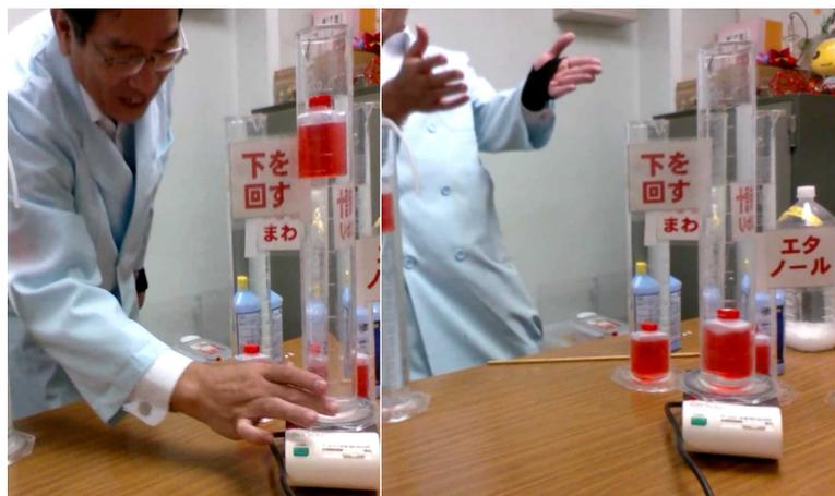
おまけの実験は、バミューダトライアングル(フロリダ半島の先の魔の三角地帯)で、船や飛行機が跡形もなく消えてしまう理由の一つと考えられる、海底火山の噴火で、大量の泡が海の底から上がってくると、水から得られるはずの浮力が、空気の泡で奪われ沈んでいく様子も披露しました。
