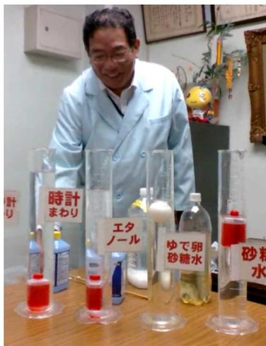
10月の続きとなる後半戦。「塩水」で浮くなら「砂糖水」で沈むかという、沈みません。砂糖水は塩水と同じように浮く力を大きくします。ゆで卵が浮いていることから分かるかと思います。水より重いものを使うと浮く力が増えて浮いてくるのです。写真を見ると、水より軽い「エタノール」を使うと、浮く力が小さくなるので沈んでしまうのも分かりますね。
