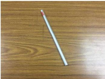
左の写真は、アルミの棒ですね。この棒を見て、「トライアングルや鉄琴」を想像した人は「達人」といえるでしょう。今回の実験は鉄琴の板を投げ落とすのと同じ実験だったのです。**同じ長さの棒は同じ高さの音を響かせる。**ここが今回のポイントでした。赤いテープを巻かれた写真の棒はト音記号のドの音です。では、下の写真を見てみましょう。赤いテープの棒（一番長い棒）が、ドの音で音階になっているとしたら、2番目の長さの黄色がレ、3番目の長さの緑がミということが分かってきますね。すると以下ようになります。
