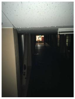
左の写真は、学校が停電したときの様子です。奥の体育館は、太陽光蓄電システムにさっと切り替わり、停電しなかったことがよく分かります。体育館への渡り廊下は、このとき激しい雨漏りで、床一面水たまりとなっていきます。天井から沢山の水滴が写真でも確認できるかと思います。雨漏り修理はしていませんが、今は拭き取るできるかと思います。 って対応しています。
