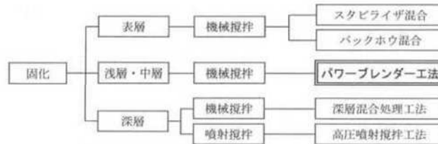
図-4.3.2 原位置試験における攪拌工法の分類
