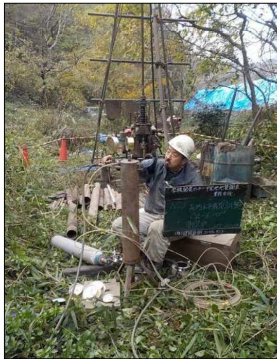
孔内水平載荷試験 (GL-6.00m)
