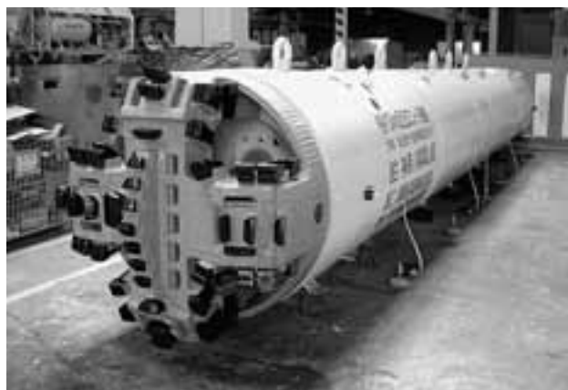
木古庭長柄幹線管渠ミニシールドマシン
