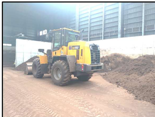
重機による切り返し
