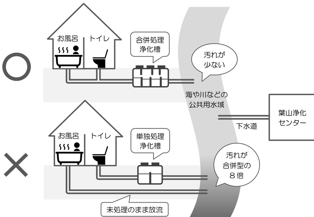
単独処理浄化槽から合併処理浄化槽への転換が進むことで
